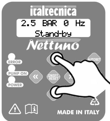
Pour accéder à ces pages, amener le dispositif en mode veille et appuyer pendant 5 secondes simultanément sur les touches + et -. Une fois entrés dans le menu caché, utiliser les touches flèche “<<” et “>>” pour faire défiler les pages-écrans et les touches + et - pour modifier les paramètres. Pour revenir à la page-écran principale, appuyer sur la touche centrale.
